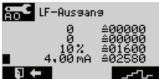
Alle Werte die in der Hardwarediagnose geändert werden, setzt das Steuergerät beim Verlassen des Menüs zurück.
